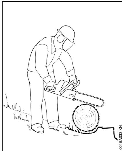
El tronzado consiste en cortar un tronco en secciones.
