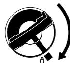
Colocar correctamente el cierre de aleta plegable (cierre de bayoneta), girarlo hasta el tope y plegar el estribo.
