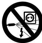
Para reducir el riesgo de producir un cortocircuito, incendios y electrocución, nunca dirija el chorro hacia aparatos y equipos eléctricos, tomas de corriente o cables eléctricos.
