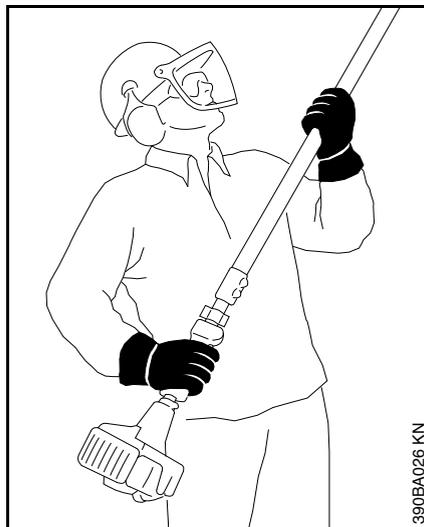
Coloque la mano izquierda sobre el eje y la derecha sobre la empuñadura trasera y el gatillo de aceleración. Las personas que trabajan con la mano izquierda (zurdos) también deben seguir estas instrucciones. Mantenga las manos en esta posición para guardar el control del podador de varilla en todo momento.
