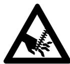
No tocar las cuchillas estando el motor en marcha. Si las cuchillas se bloquean con algún objeto, parar inmediatamente el motor – quitar sólo entonces el objeto – **¡peligro de lesiones!**
