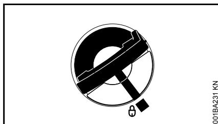
Entonces quedan alineadas entre sí las marcas en el cierre del depósito y en el depósito de combustible
