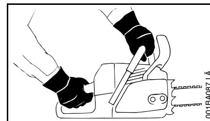
Sujetar la motosierra siempre **con ambas manos**: la mano derecha, en la empuñadura trasera – también los zurdos. Para guiarla de forma segura, asir firmemente el asidero tubular y la empuñadura con los pulgares.
