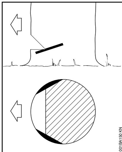
Los cortes de albura impiden que se desgarre la albura al talar el tronco en maderas de fibras largas; cortar en ambos lados del tronco a la altura de la base de la muesca de caída hasta aprox.  $1/10$  del diámetro del tronco. Si se trata de troncos de cierto grosor, cortar hasta el ancho de la espada, como máximo.
