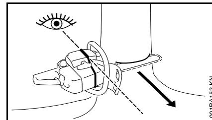
Esta motosierra está provista de una marca de talado en la cubierta y la caja del ventilador. Emplear esta marca de talado.
