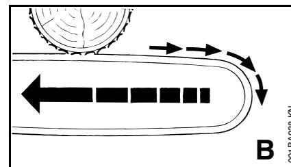
Cuando, al cortar con el lado superior de la espada – corte del revés – la cadena se aprisiona o topa en un objeto sólido en la madera, la motosierra puede retroceder de golpe hacia el operario – **para evitarlo:**
