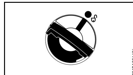
Las marcas en el cierre del depósito y en el depósito de combustible tienen que estar alineadas entre sí
