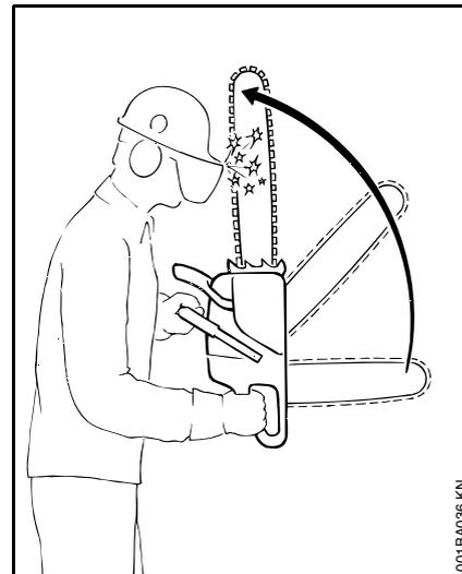
Al producirse un rebote (kickback), la sierra es lanzada repentinamente y de forma incontrolable hacia el operario.
