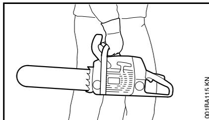
Llevar la motosierra sólo por el asidero tubular – el silenciador caliente, apartado del cuerpo; la espada, orientada hacia atrás. No tocar piezas calientes de la máquina, en especial la superficie del silenciador – ¡peligro de quemaduras!
