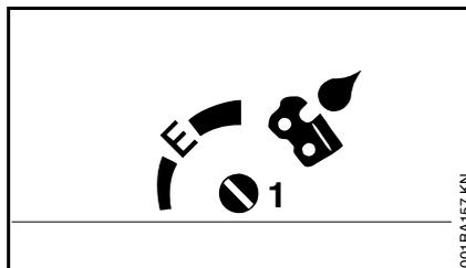
Con el perno de ajuste (1) (en la parte inferior de la máquina) se puede ajustar el caudal de aceite a suministrar según las necesidades.
